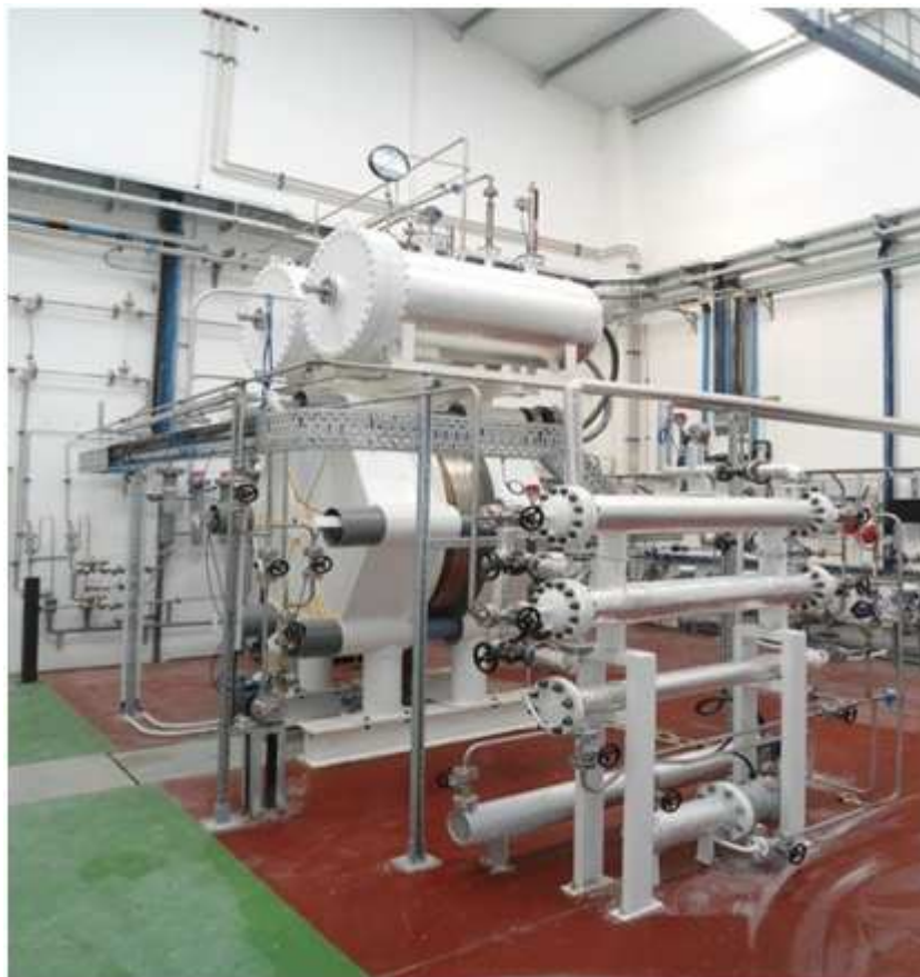
Ilustración 9. Sistema de generación de hidrógeno renovable basado en electrólisis alcalina.
