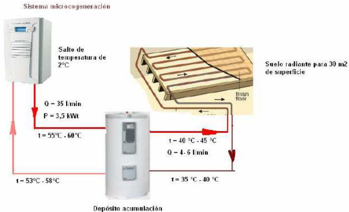
Ilustración 15. Operación del sistema de pila de cogeneración en su integración en el edificio de FHA en sistema de suelo radiante para alimentar una de las dependencias del edificio.
