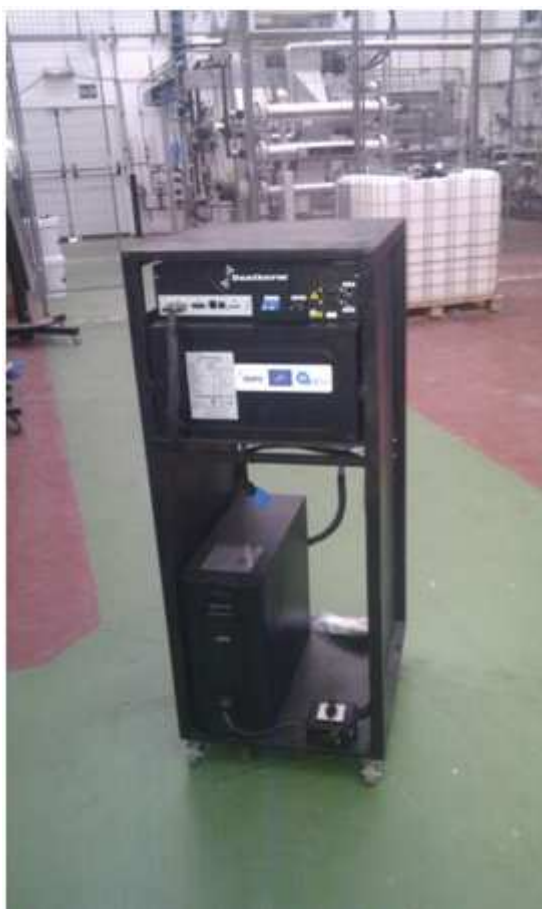
Ilustración 18. Sistema de SAI basado en pila de combustible.
