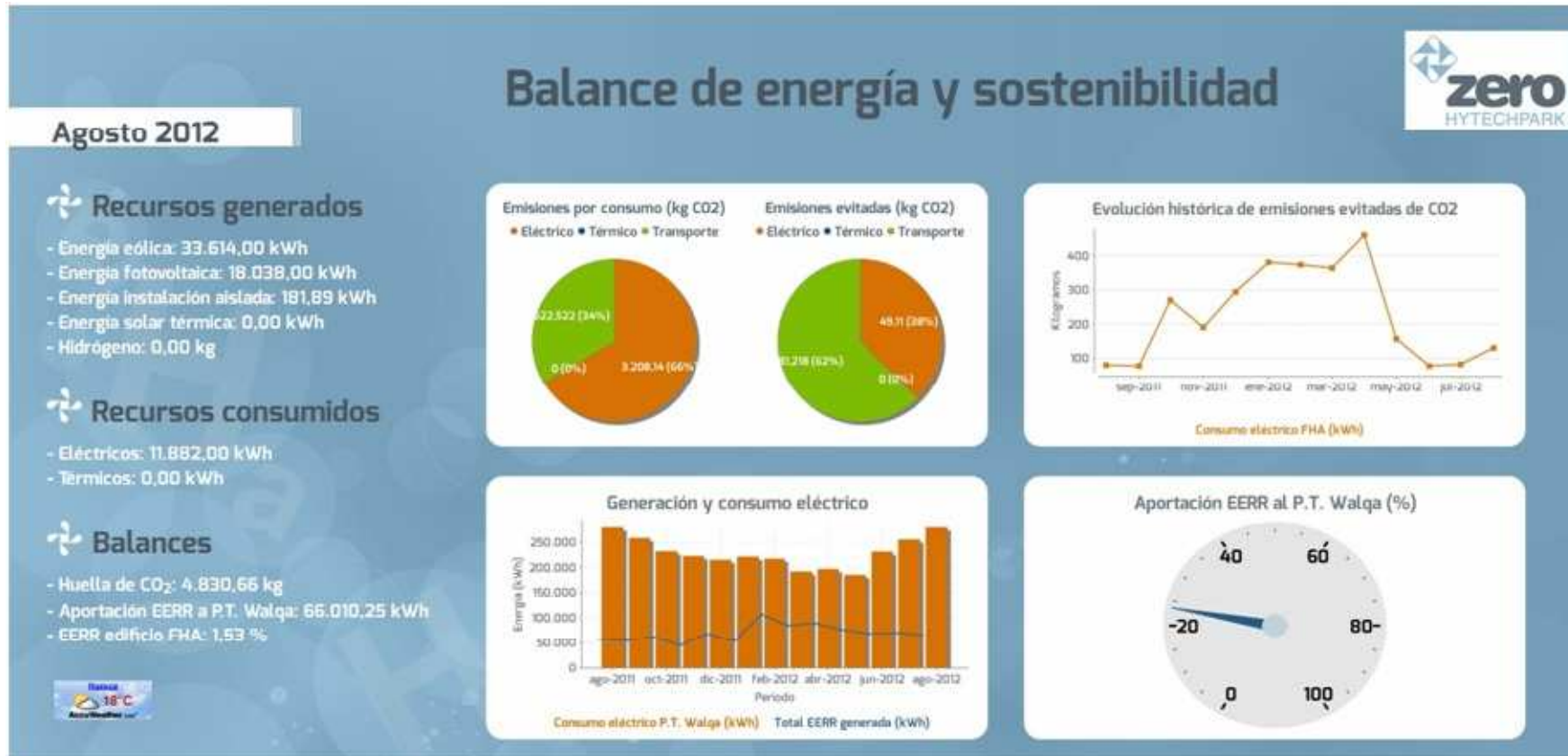
Ilustración 8. Pantalla de la aplicación de balance de energía y sostenibilidad del proyecto Zerohytechpark
